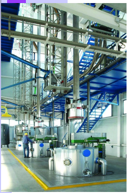
コルクからの2,4,6-トリクロロアニソール(TCA)の抽出(スペイン) 3×8300 L(15 MPa) → 「DIAMコルク」として販売 ☆現時点で世界最大の超臨界二酸化炭素抽出プラント
