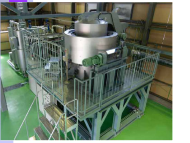
超臨界二酸化炭素洗浄装置(洗浄槽容積: 1.5 m 3 )(ダイダ(株)のプレスリリースより引用)
