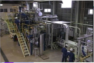
超臨界CO 2 抽出によるフレーバー成分抽出プラント(曾田香料(株))
