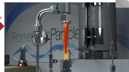
超臨界水熱合成法によるナノ粒子合成装置 (Promethean Particles Ltd.製, Institute of Physics (IOP)のHPより引用)
