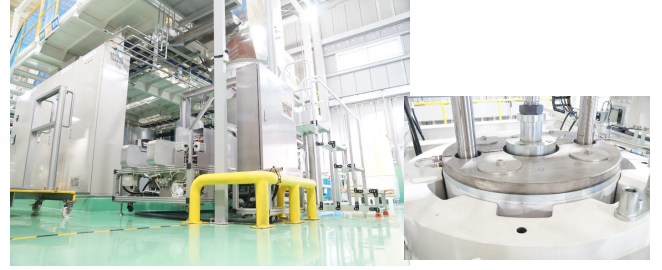
超臨界CO 2 抽出による脱カフェインプラント(超臨界技術センター(株)製, (株)堀口珈琲のHPより引用: https://www.kohikobo.co.jp/channel/16517/ )
