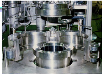
超臨界CO 2 抽出装置 (最大600 L)(三菱化工機(株)製, 会社HPより引用)
