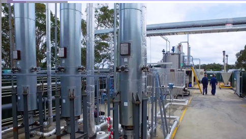
超臨界水酸化(SCWO)によるプラスチックの油化技術(HydroPROSTM) (Mura Technology Ltd.のHPより引用)
