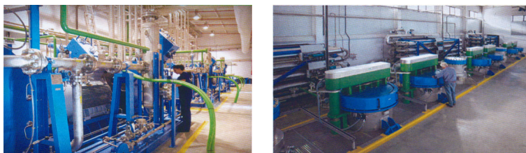
コルクからの2,4,6-トリクロロアニソール(TCA)の抽出(スペイン) 3×8300 L(15 MPa) → 「DIAMコルク」として販売 ☆現時点で世界最大の超臨界二酸化炭素抽出プラント
