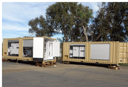
超臨界水酸化(SCWO)に廃棄物処理装置 (General Atomics Electromagnetic Systems (GA-EMS)社の(iSCWO), 会社のHPより引用)
