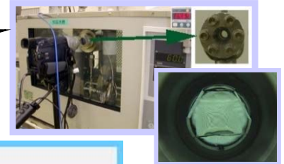
小型試験装置例 (高温槽利用) (小サンプルでの 評価、条件探索) (写真:エアロゲル)
