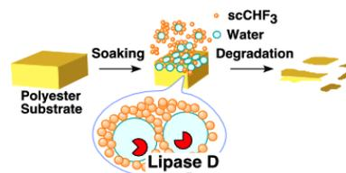
図 6 ポリエステル基板の超臨界流体エマルジョン中のエステル加水分解酵素による分解反応
